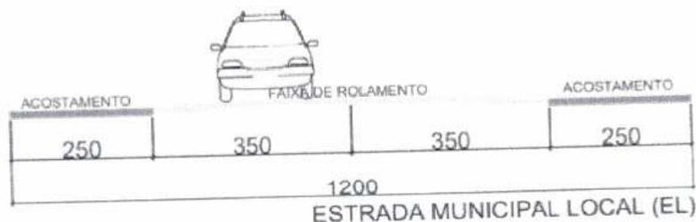
Entretanto, a mesma não possui espaço útil para a realização de acostamento, devendo ser realizado apenas no lado direito do sentido Norte-Sul para facilitar a subida ou descida de veículos de maior porte visando que a curva possui inclinação e curvatura acentuadas.
